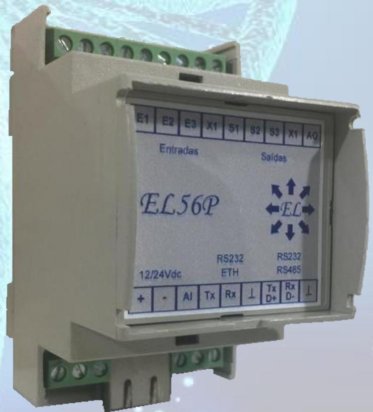
O EL-56P permite a supervisão dos pontos de incêndio das Centrais de Incêndio Simplex em protocolo Modbus TCP. Para cada ponto é possível supervisionar os seguintes estados:
