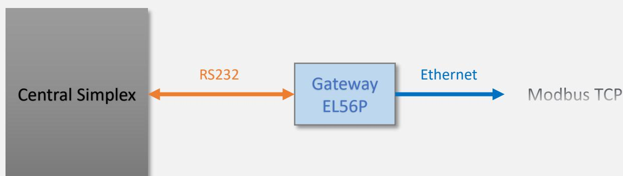
\* A central de incêndio Simplex necessita de uma placa de comunicação serial RS232
