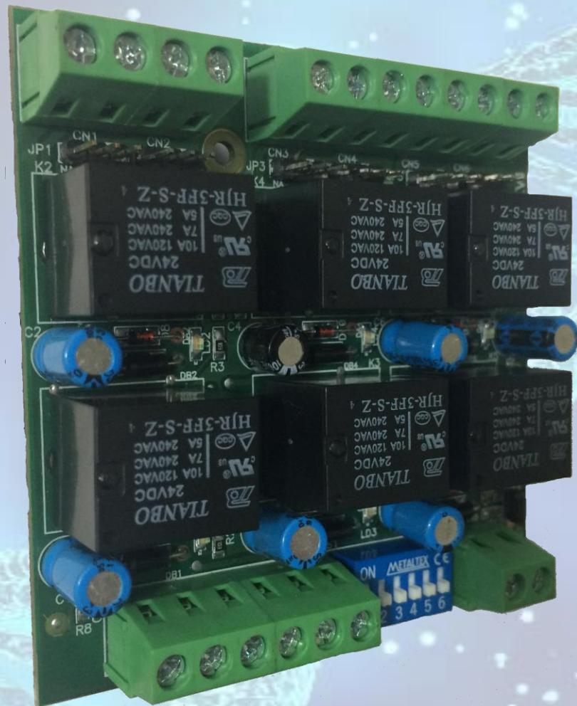
O EL\_RELE6 é um equipamento desenvolvido para atender aplicações onde é necessário controlar dispositivos através de contatos secos de rele a partir de saídas digitais de CLP.
